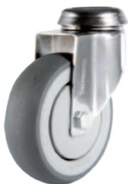
Rodachinas giratorias altamente resistentes; ensambladas en un tenedor giratorio fabricado en acero cromado y rueda en caucho termoplástico. Silenciosa, amortiguada, que no marca los pisos, con balineras de precisión con o sin freno total.
